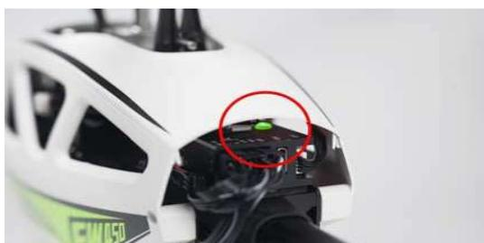
4. Entriegeln Sie die Taste wie in der Abbildung gezeigt und halten Sie sie etwa 5 Sekunden lang gedrückt, bis das H1-Flugsteuergerät grün blinkt.
