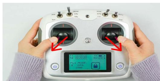
5. Während das grüne Licht blinkt, drehen Sie den Stoppschalter in die Laufposition, und der Hubschraubermotor startet, das Licht leuchtet durchgehend grün, wiederholen Sie den Entsperrvorgang erneut.
