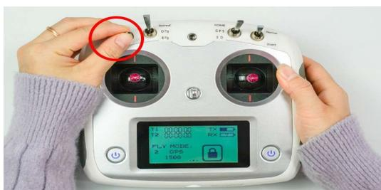
6. Wenn die Drehzahl des Hubschrauberrotorkopfes stabil ist, drücken Sie den Gashebel nach oben, um den Hubschrauber zu starten und über dem Boden anzuheben, lassen Sie dann den Gashebel los und Sie können entsprechend schweben.
