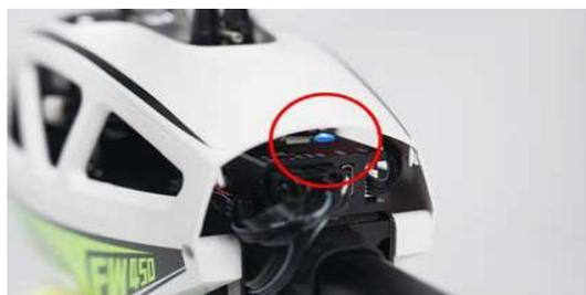
3. Entriegeln Sie die Taste wie in der Abbildung gezeigt und halten Sie sie etwa 5 Sekunden lang gedrückt, bis die Flugkontrollleuchte blau blinkt.
