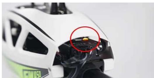
3. Nach einigen Minuten Wartezeit wechselt das Licht von gelb blinkend zu durchgehend grün. Der Hubschrauber wurde erfolgreich positioniert
