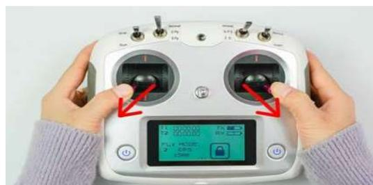
4. Während das blaue Licht blinkt, schaltet sich der Motorschalter in die Laufposition und der Hubschraubermotor läuft. Drücken Sie den Gasknüppel zum Abheben nach oben.
